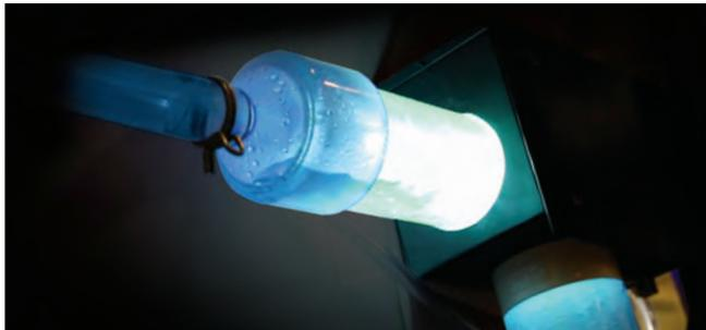
**UV-C-LICHT** Wenn Wasser mit keimtötendem UV-C-Licht bestrahlt wird, werden Mikroorganismen deaktiviert und Chloramine aufgespalten.
