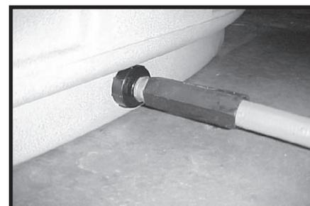
Die Ablassventileinheit des Whirlpools besteht aus einem Gartenschlauchanschluss mit einem aufschraubbaren Ventil sowie einer Schutzkappe für die Ablassöffnung und befindet sich hinter dem Wasserfall (außen) im unteren Bereich des Whirlpools.
